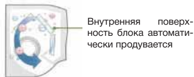
Кондиционер с функцией самоочистки испарителя
