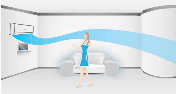
В режиме охлаждения воздушный поток направляется вдоль плоскости потолка для более интенсивного охлаждения воздуха в помещении.
