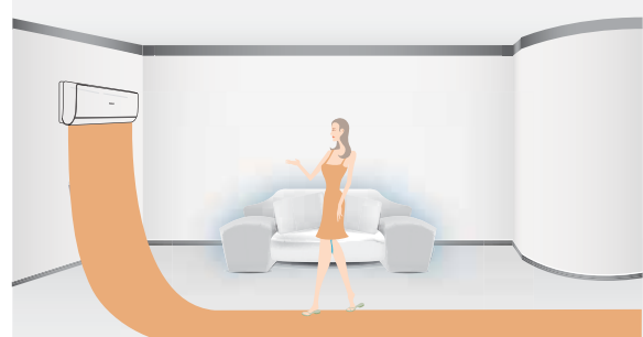
В режиме обогрева теплый воздушный поток направляется почти вертикально вниз для более интенсивного прогрева воздуха в помещении.
