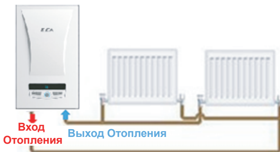
Рисунок 8. Схема подключения устройства СН
