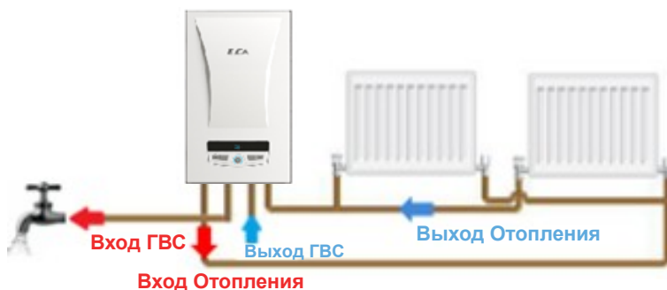
Рисунок 7. Схема Подключения Установки Монотермического Устройства.
