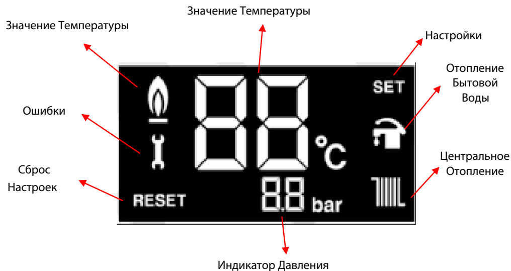
Рисунок 17. Символы на ЖК-дисплее и их Значение
